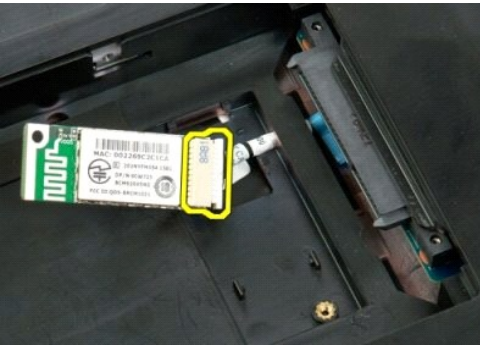
7. ถอดโมดูล Bluetooth ออกจากเครื่องคอมพิวเตอร์
