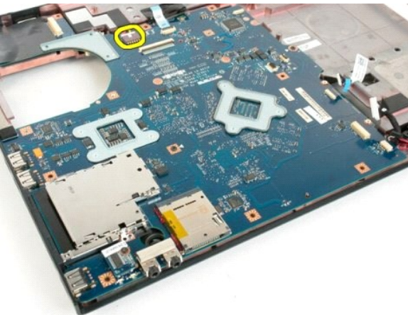
15. ถอดสกรูสามตัวที่ยึดบอร์ดระบบเข้ากับตัวเครื่องคอมพิวเตอร์
