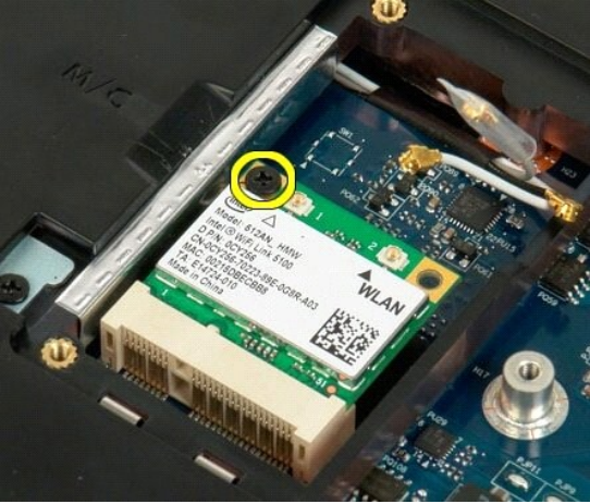
6. ถอดการ์ด WLAN ออกจากเครื่องคอมพิวเตอร์
