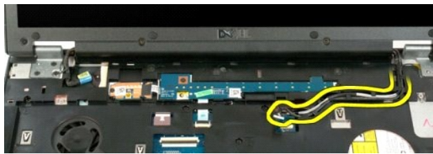
9. ถอดสายข้อมูลของจอแสดงผลออกจากนอร์ระบบ
