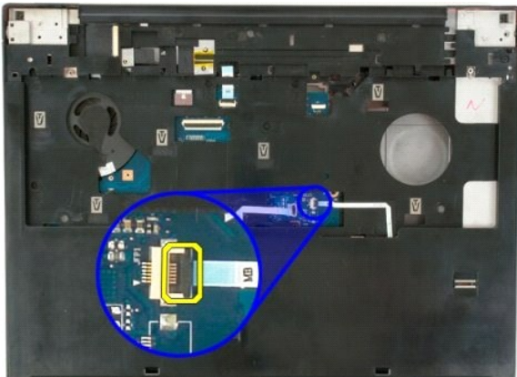
10. ถอดสายข้อมูลของตัวอ่านลายนิ้วมือออกจากคลิปหนีบสาย
