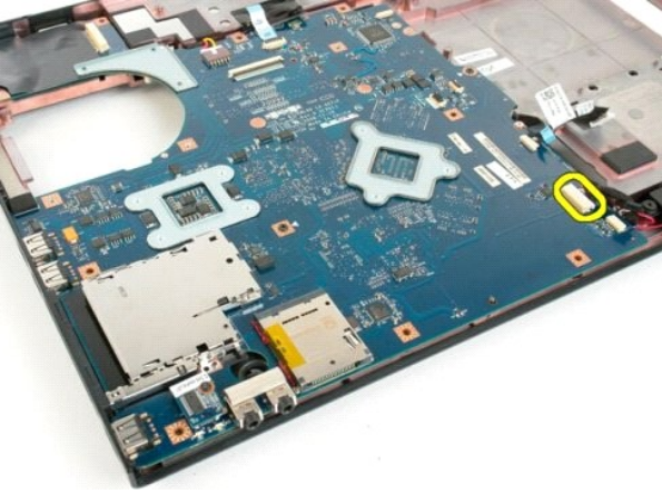
13. ถอดสายขั้วของโมดูล Bluetooth® ออกจากบอร์ดระบบ
