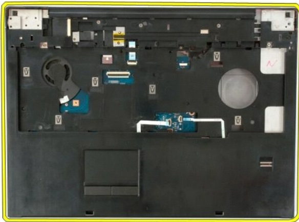
12. ถอดที่วางฝ่ามือออกจากเครื่องคอมพิวเตอร์
