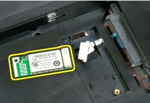
7. ถอดโมดูล Bluetooth ออกจากเครื่องคอมพิวเตอร์
