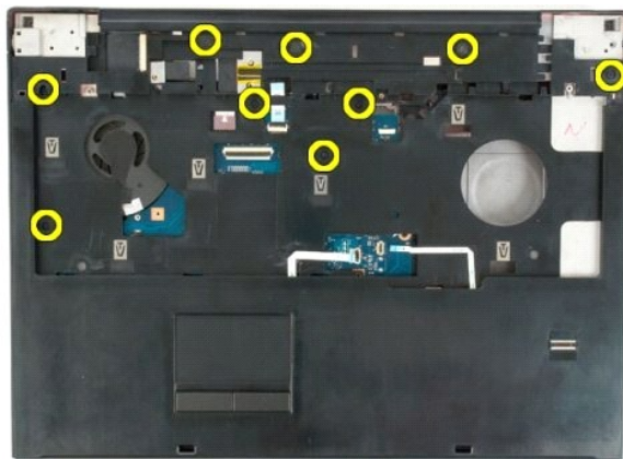
12. ถอดที่วางฝ่ามือออกจากเครื่องคอมพิวเตอร์
