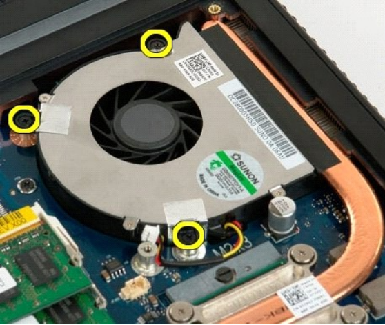
6. ยกตัวพัดลมขึ้นและถอดออกจากเครื่องคอมพิวเตอร์
