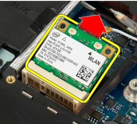
6. ถอดการ์ด WLAN ออกจากเครื่องคอมพิวเตอร์
