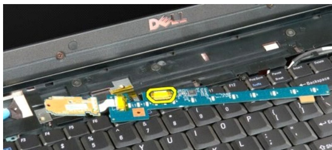
10. นำแผงปุ่มทั้งสองออกจากเครื่องคอมพิวเตอร์
